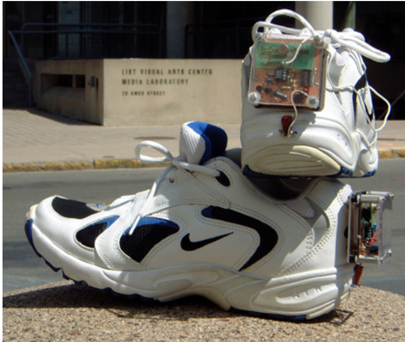
Heel strike generator: Paradiso et al, MIT
